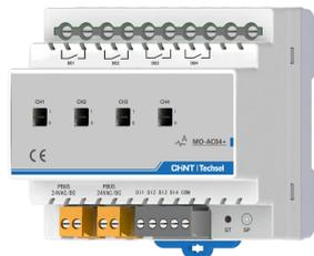
MO-AC04+是SMC系列开关量模块产品之一，广泛应用于智能照明、安防报警、电动窗帘等机电设备控制领域，具有4路开关量输入、4路继电器输出、4路电流检测功能；开关量输入可接入开关、报警、红外人体感应器等信号，继电器输出可控制照明、电机、报警等开关回路，每个继电器输出回路均带电流检测功能。
