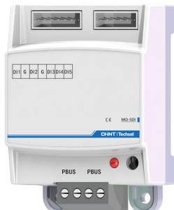
MO-5DI是SMC系列开关量模块产品之一，广泛应用于智能照明、安防报警等机电设备控制领域，具有5路开关量输入；开关量输入可接入开关、报警、红外人体感应器等信号，或接入传统照明开关信号，将外接信号转换成总线信号进行系统的联动控制。
