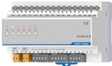
MO-4FD-2A是SMC系列调光模块产品之一，广泛应用于智能照明、智能家居、客房控制等控制领域，具有4路开关量输入以及4路2A前向沿可控硅调光输出功能；开关量输入可接入开关、报警、红外人体感应器等信号，调光输出有白炽灯、卤素灯，前相控电子变压器等其他阻性负载可调光源。
