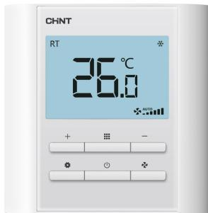
**TFP210A、TFP210B**是我司自主研发的一体式联网型风机盘管温控器，它集房间温控校正系数设定，环境温度设定，风机盘管运行方式设定以及时间计量功能于一身，通过采集高精度传感器信号与设定温度进行比较，根据设定的工作方式，输出控制信号，自动控制电动阀和风机，达到保持室内恒温的目的，适用于四管制的末端空调系统。具有RS485/PBUS，配合空调网关可实现空调远程管理和计量计费等功能。
