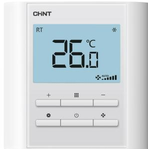
**TFP211A、TFP211B**是我司自主研发的一体式联网型风机盘管温控器，它集房间温控校正系数设定，环境温度设定，风机盘管运行方式设定以及时间计量功能于一身，通过采集高精度传感器信号与设定温度进行比较，根据设定的工作方式，输出控制信号，自动控制电动阀和风机，达到保持室内恒温的目的，适用于两管制的末端空调系统。具有RS485/PBUS通讯接口，配合空调网关或可实现空调远程管理和计量计费等功能。
