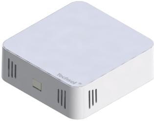
SIPMVA10是空气环境传感器产品之一，广泛应用于建筑智能楼宇工程中室内空气质量的PM2.5浓度的实时监测，采用进口数字传感器，克服传统模拟式传感器不稳定、误差大、易受干扰、需定期校准等严重缺陷。同时具有采集精确可靠、外形小巧美观、防浪涌电压、无极性供电通讯等优点，广泛应用于商业办公、地铁、医院、图书馆等建筑环境控制场合。
