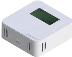
SIVOCB11 是空气环境传感器产品之一，广泛应用于建筑智能楼宇工程中室内空气质量 VOC 浓度参数的实时监测，采用进口数字传感器，克服传统模拟式传感器不稳定、误差大、易受干扰、需定期校准等严重缺陷。同时具有采集精确可靠、外形小巧美观、防浪涌电压、无极性供电通讯等优点，广泛应用于商业办公、地铁、医院、图书馆等建筑环境控制场合。
